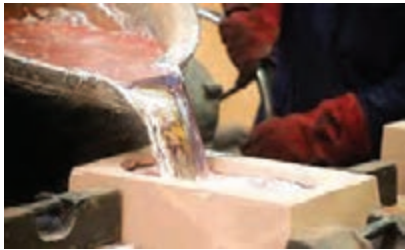
شکل ۳- ریخته‌گری فلز آلومینیوم
