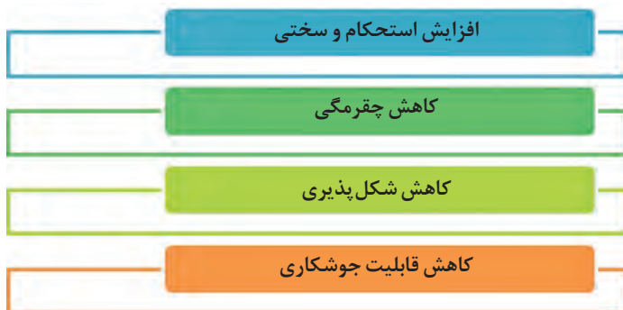
نمودار ۹- اثر افزودن کربن بر خواص فولاد
