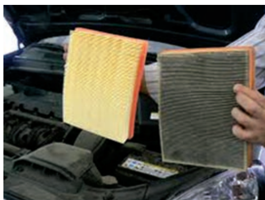
شکل ۲۲ - فیلتر هوای تمیز و کار کرده
