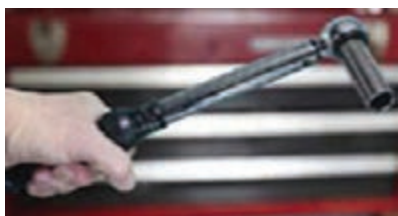
شکل ۲۴- آچار ترک یا آچار گشتاور
