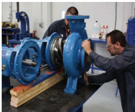
شکل ۲- تعمیر اساسی پمپ در کارگاه مکانیک
