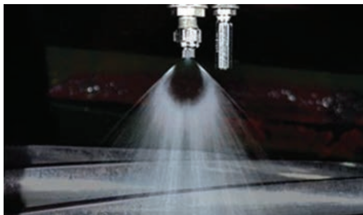
شکل ۲۰- روغن‌کاری پاششی
