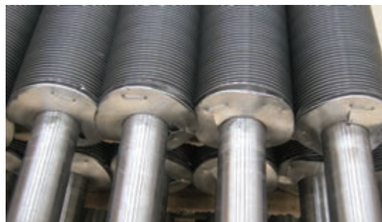
شکل ۲۶- لوله‌های پره‌دار در خنک‌کننده‌های هوایی
