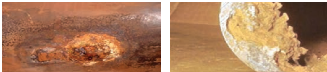
شکل ۳- برآمدگی و خوردگی ناشی از تشکیل رسوب
