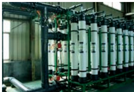
شکل ۱۰- نمایی ساده و واقعی از فرایند اولترافیلتراسیون
