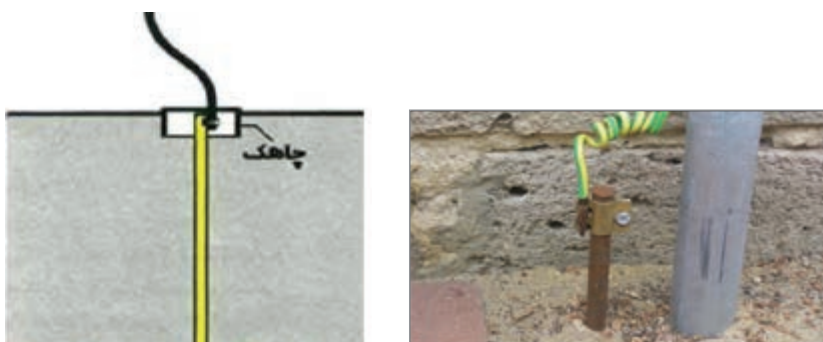
شکل ۴ - شیوه اتصال به چاه ارت
