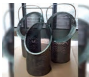
شکل ۳۵- یک نمونه فیلتر اولیه سوخت
