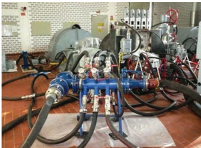
شکل ۳۰- سامانه تمیزکاری کمپرسور
