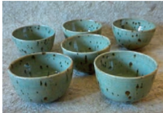
شکل ۵۶- اثر افزودن ۴ درصد بنتونیت در ترکیب لعاب
