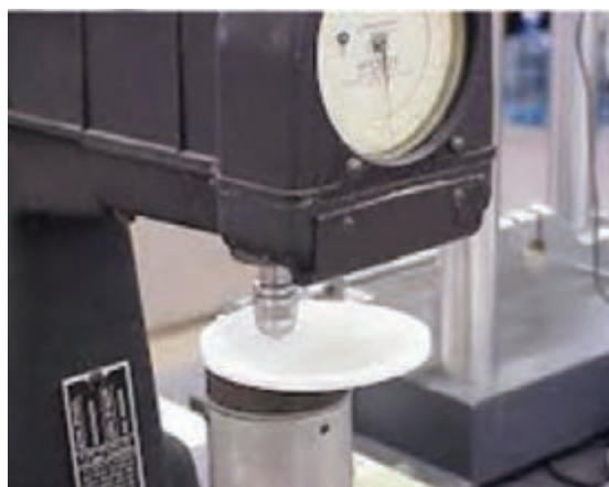
شکل ۱۹- روش‌های دستی و دستگاهی تعیین سختی
