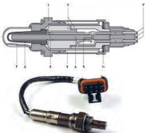
شکل ۵- اجزای حسگر اکسیژن
