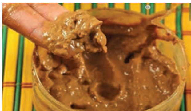
شکل ۵۵- بنتونیت آب جذب کرده و متورم شده
