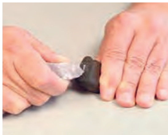
شکل ۱۹- روش‌های دستی و دستگاهی تعیین سختی
