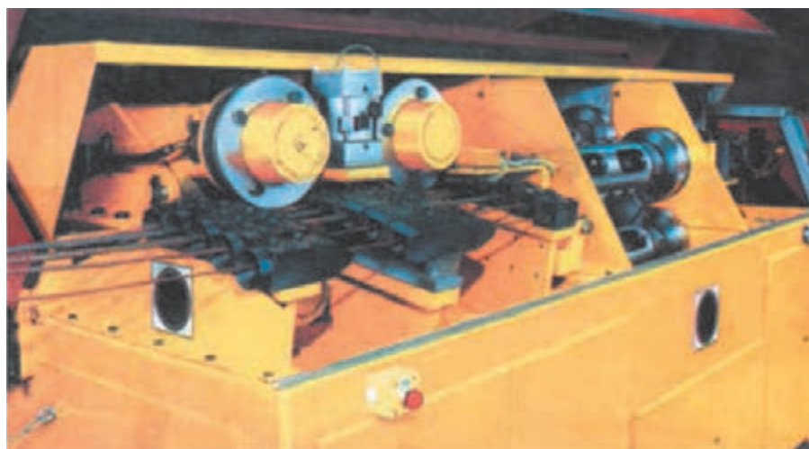
شکل ۲۹ - دستگاه کشش برقی برای صاف کردن میلگرد ▲
