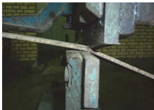
شکل ۲۹- نفوذ تیغه‌ها در قطعه
