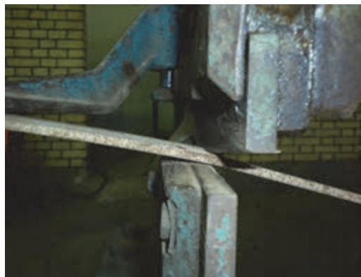
شکل ۲۸- ایجاد شیار آغازین در قطعه
