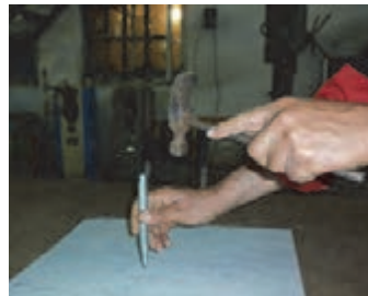
شکل ۱۳- استفاده از سنبه برای نشانه‌گذاری
