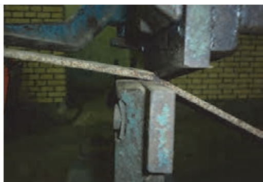
شکل ۳۰- شکست قطعه در انتهای برش کاری
