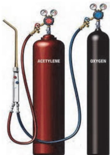
شکل ۲۹- یک واحد جوش کاری گاز
