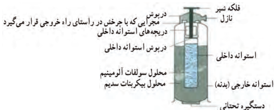
شکل ۳-۷ خاموش کننده دستی حاوی پودر آتش‌نشانی
