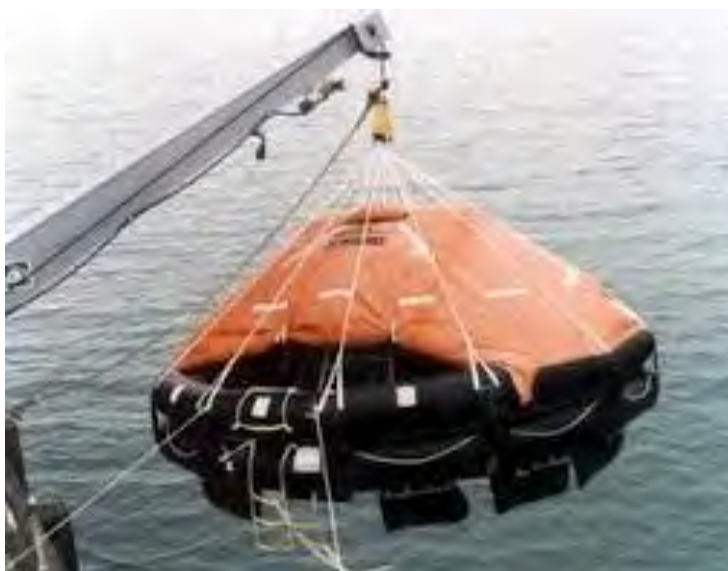
شکل ۴-۱۵ به آب‌اندازی با جرثقیل
