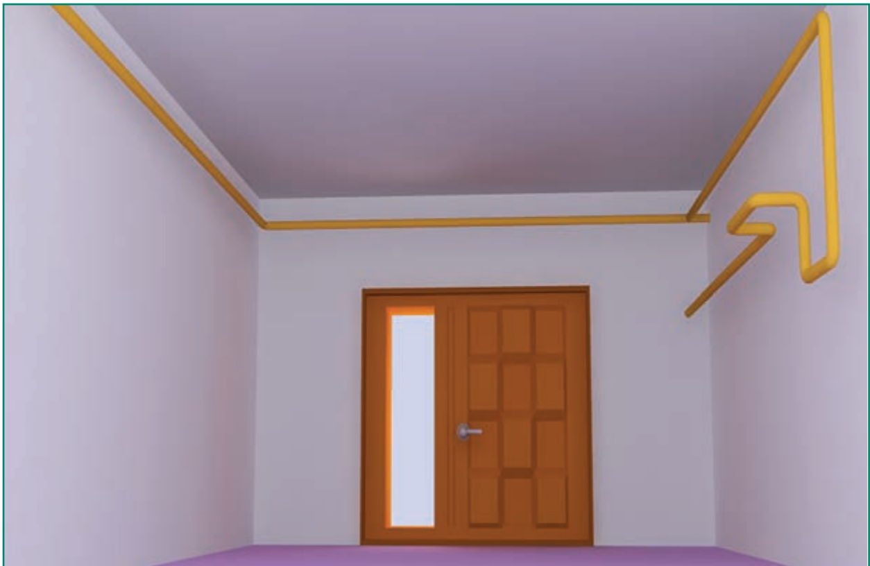
شکل ۴-۲۳ الف نمایش مسیر لوله‌ها در داخل راهرو
