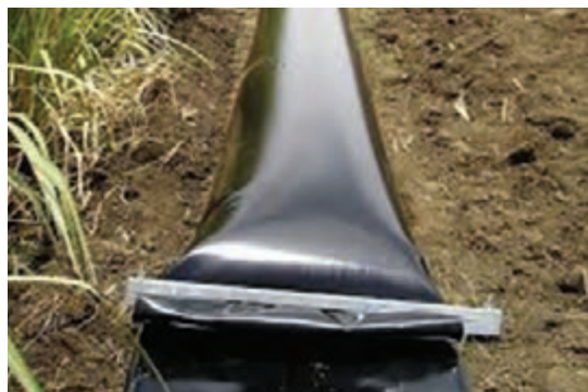
شکل ۱۱- لوله هیدروفلوم با گیره انتهایی
