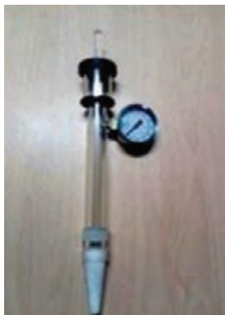
تانسیومتر آنالوگ مدل آب ۳۰ سانتی‌متری
