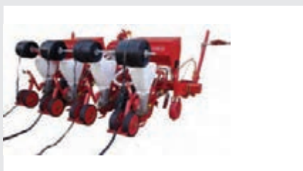
شکل ۱۴- استقرار نوار تیپ با ماشین کاشت
