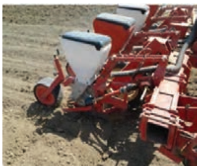
شکل ۱۴- کشت سویا با ردیف کار پنوماتیک دوردیفه
