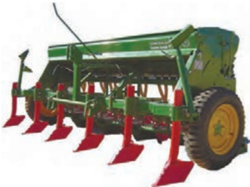
شکل ۷- خطی کار دارای فاروئر
