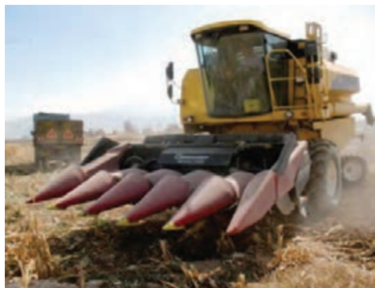
شکل ۱۲- کمباین دارای هد مخصوص برداشت ذرت دانه‌ای
