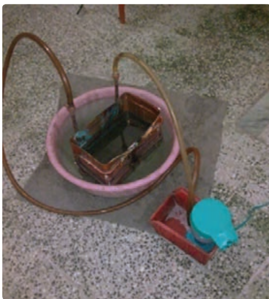
شکل ۱۹- رسوب‌زدایی با پمپ
