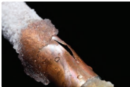
شکل ۶- شکستن لوله آب در اثر انجماد آب
