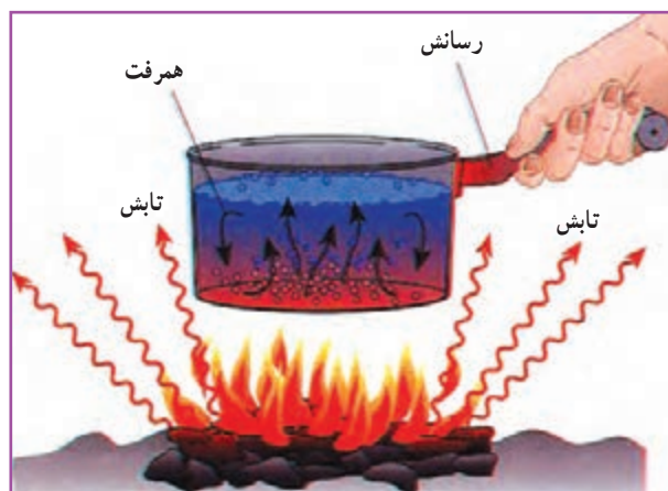
شکل ۱۱- انتقال گرما به هر سه روش
