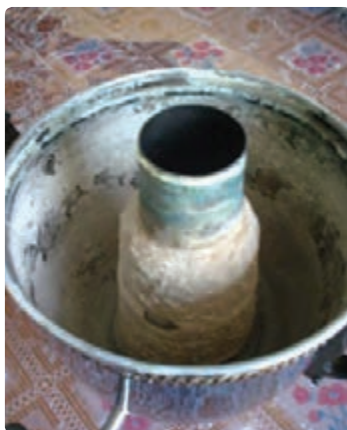
شکل ۸- تشکیل رسوب در سماور و لوله‌ها
