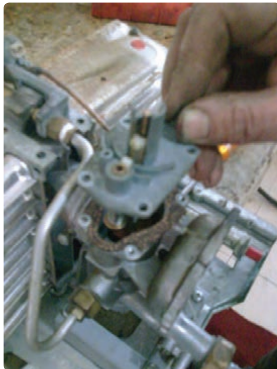
شکل ۲۰- رگولاتور گاز بر روی آب گرم کن
