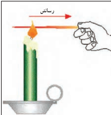
شکل ۸- رسانش در یک میله فلزی
