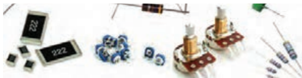
انواع مقاومت ثابت
