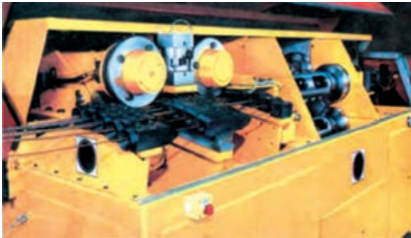
دستگاه کشش برقی برای صاف کردن میلگرد
