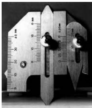
شکل ۳- ابزار اندازه گیری بعد جوش
