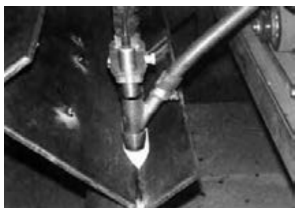
جوشکاری زیر پودری
