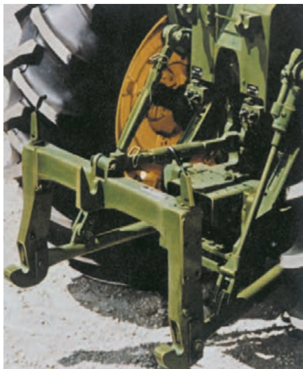
شکل ۲-۶۵- مالبند اتصال سریع
