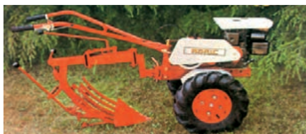
شکل ۶۹-۲- گاو آهن دو طرفه
