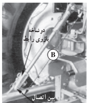
در تراکتور جاندیر ۳۱۴۰ طول بازوها (B) باید بین ۹۰۷-۷۶۰ میلیمتر باشد.
