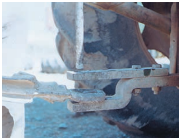
شکل ۳۶-۱ باز کردن پی نورد از تراکتور
