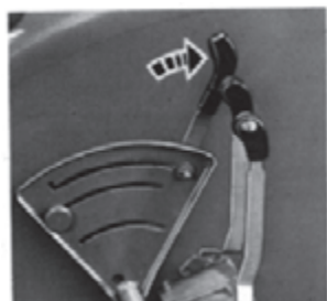
شکل ۲-۶- اهرم اصلی هیدرولیک تراکتور JD 3140 در وضعیت بالا
