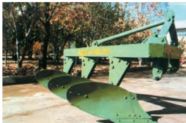
شکل ۲-۳۶- گاوآهن سوار سه خیش
