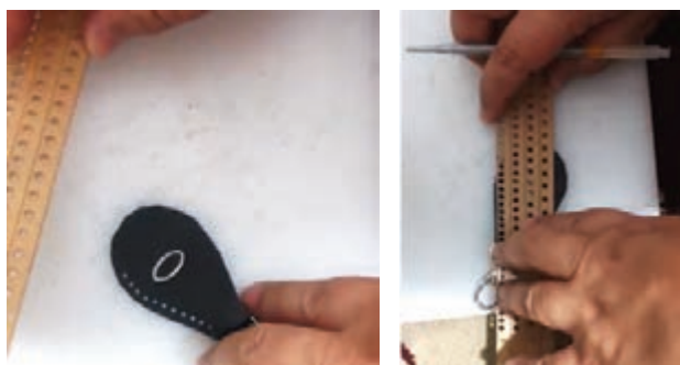
تصویر ۷۷- تعیین محل سمبه زدن (مراحل کار از سمت راست به چپ)
