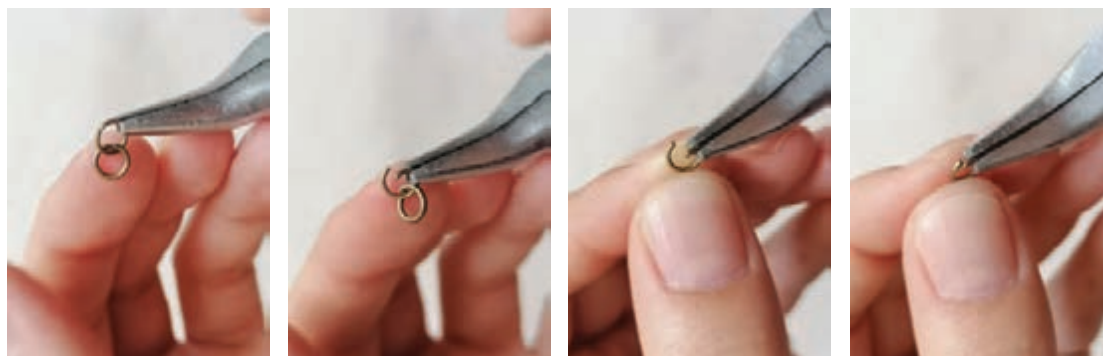
تصویر ۸۹- حلق G اتصال (مراحل کار از سمت راست به چپ)
