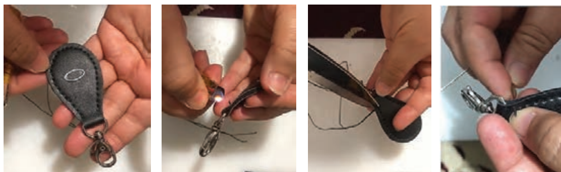
تصویر ۷۸- دوخت دورتادور جاسوئیچی (مراحل کار از سمت راست به چپ)
