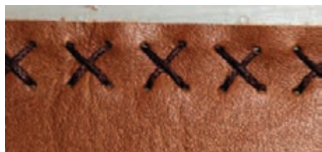
تصویر ۷۲- دوخت ضربدري (میانه کار)
