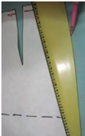
تصویر ۶۹- قرارگیری الگوی دامن روی پارچه
