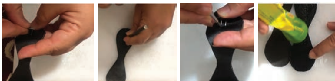
تصویر ۷۵- چسب کاری الگوهای چرم (سمت راست) - تعیین و نصب محل نشان (وسط و چپ)
