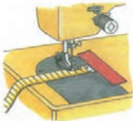
تصویر ۴۵ - تنظیم فاصله بین لبه پارچه تا بخیه
