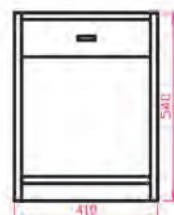
نمای کابینت پاتختی بدون در، با جعبه و با پاستنگ (عمق ۳۰۰)
