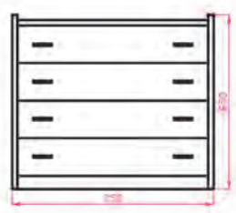
نمای کابینت درآور ۴ کشو، بدون پاستنگ (عمق ۳۵۰)
