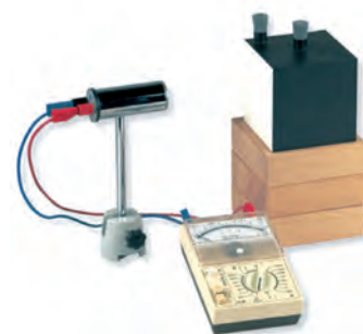
شکل ۴-۳۳ درون مکعب لسی، آب داغ می‌ریزند. تابش گرمایی از چهار وجه مکعب که رنگ‌های متفاوتی دارند، با هم فرق دارد.
