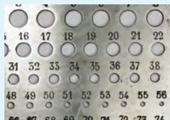
شابلون میله (اندازه گیری قطر میله‌ها)
