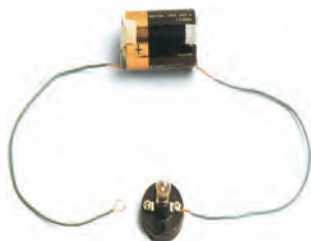
شکل ۵-۸ قطع شدگی در مدار
