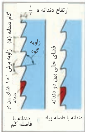
شکل ۱- تیغ اره نواری مناسب برش های طولی
