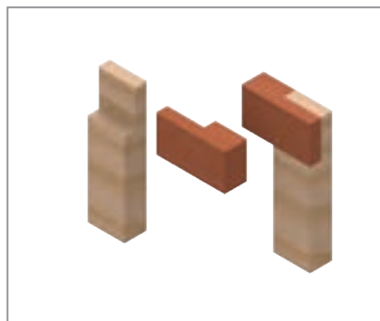
شکل ۱- اتصال گوشه‌ای نیم و نیم ساده.
