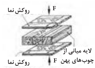
تخته چندلایه مطبق ST: پهنای چوب میانی ۷ تا ۳۰ میلی‌متر متغیر است. (تخته بلوکی)
