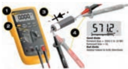
شکل ۳۲- تست دیود ناسالم و اتصال کوتاه
