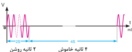
شکل ۸۴ - مشخصات سیگنال باز تاب زنگ
