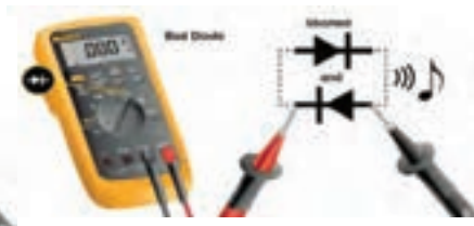
شکل ۳۳- دیود معیوب و اتصال کوتاه
