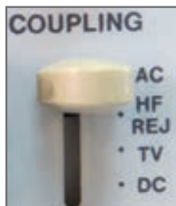
شکل ۷۴- وضعیت‌های کلید کوپلینگ
