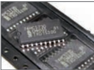
شکل ۱۸- تصویر ظاهری انواع پکیج‌ها SOIC
