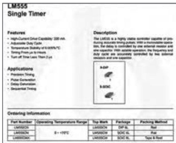
شکل ۱۲ - یک نمونه برگه اطلاعات تایمر LM555
