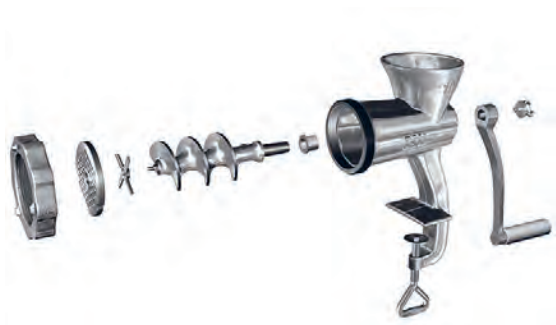
شکل ۶۷- تصویر سه بعدی انفجاری چرخ‌گشت دستی
