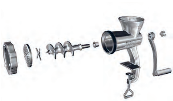
شکل ۶۷- تصویر سه بعدی انفجاری چرخ‌گشت دستی
