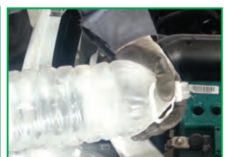
ث - به باتری آب مقطر اضافه کنید.
