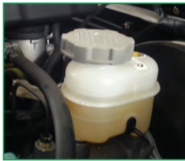
شکل ۸-۵ - مخزن مایع ترمز
