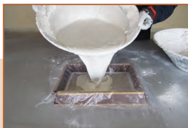
ث - ریختن ملات گچ در قالب
