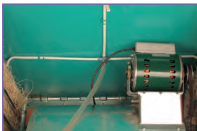
ح - آزمایش صحت مدار آب پخش کن
