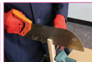
ث - اره کاری شیار بازوی چوبی
