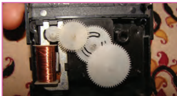
ب- بعد از باز کردن موتور ساعت
