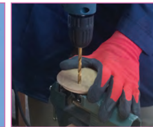
ث - سوراخ کاری قطعات
