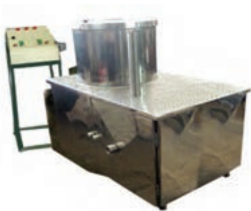
شکل ۳- دستگاه مخلوط‌کن خمیر کیک با پمپ تخلیه
