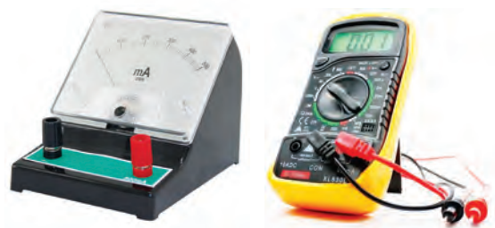
شکل ۵-۶ نمونه‌هایی از آمپرسنج
