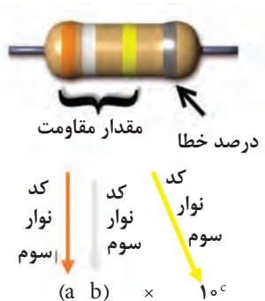
شکل ۵-۱۶ نحوه خواندن مقاومت رنگی
