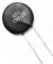
شکل ۵-۱۸ مقاومت‌های وابسته به حرارت
