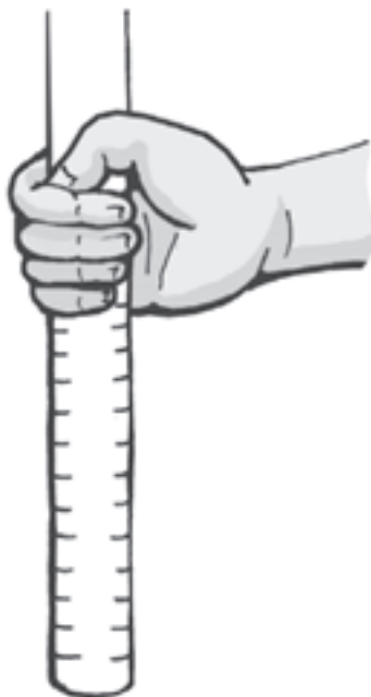
شکل ۲-۹- روش اندازه‌گیری آزمون خطکش
