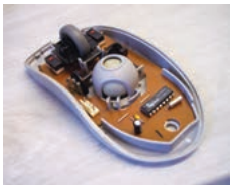
شکل ۲۶-۶ درون ماوس مکانیکی - نوری
