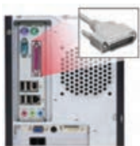
شکل ۱۸-۶ چاپگر لیزری HP Laser Jet ۱۵۱۵ (سمت راست)، محل اتصال درگاه موازی LPT (سمت چپ)
