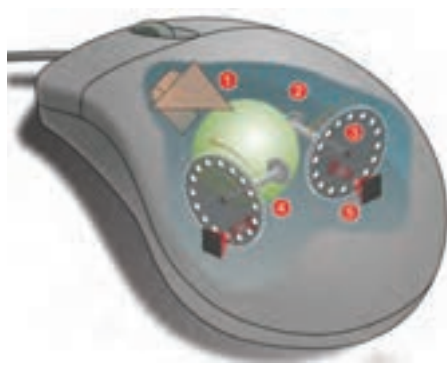
شکل ۲۶-۶ درون ماوس مکانیکی - نوری
