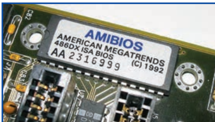
شکل ۲۵-۴ نوعی بایاس روی حافظه فلش
