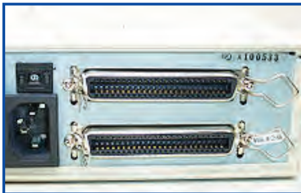
شکل ۴-۴۶ کانکتور اسکازی روی دیسک سخت خارجی
