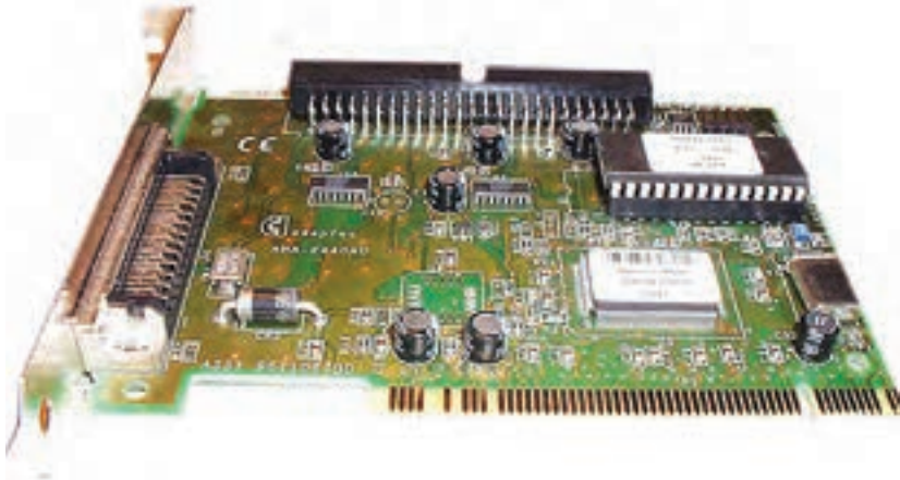
شکل ۴-۵۲ کارت رابط اسکازی SCSI
