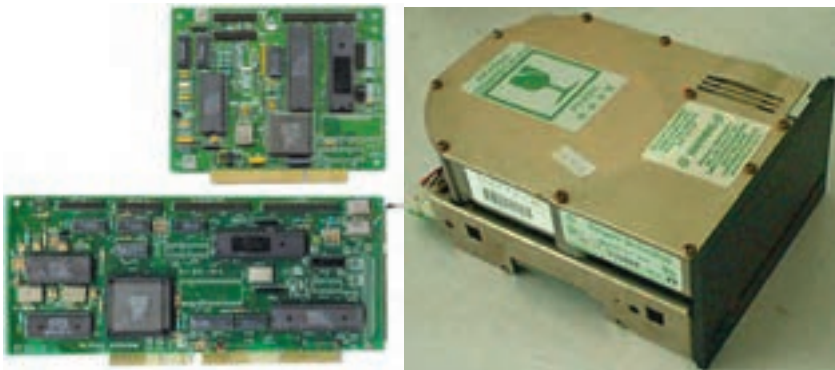
شکل ۴-۴۴ اولین دیسک سخت در رایانه‌های شخصی به نام ST-506 و کارت‌های رابط آن (بالایی در رایانه‌های XT و پایینی در رایانه‌های AT)
