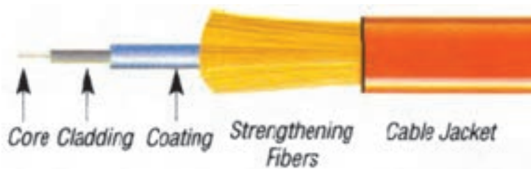
شکل ۸-۴- اجزای تشکیل‌دهنده یک کابل فیبر
