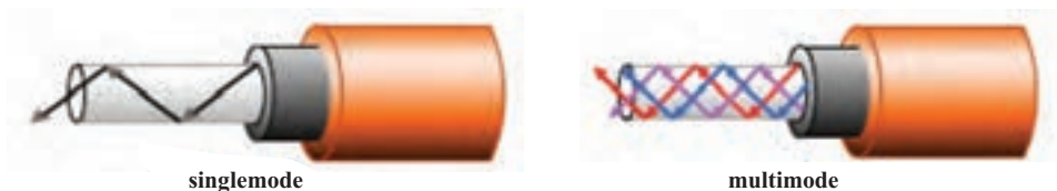
شکل ۱۱-۴- فیبر تک حالت و چند حالت
