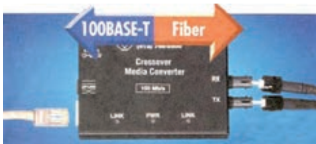
شکل ۱۷-۴- مبدل فیبر نوری به سوکت RJ45
