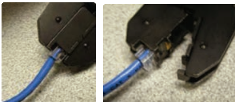
شکل ۴۷- پرس سوکت‌های کابل شبکه
