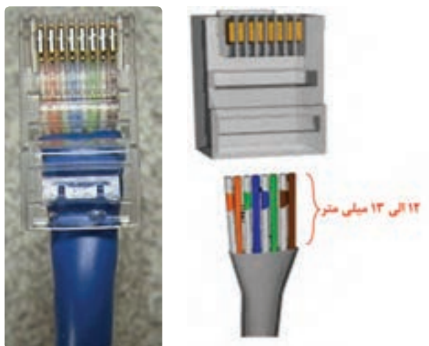
شکل ۴۶- سوکت زدن به سر کابل
