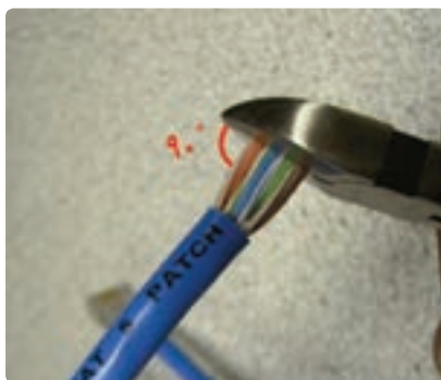
شکل ۴۵-۴- برش سیم‌های کابل شبکه
