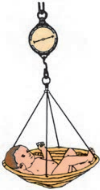
شکل ۹-۱۷- ترازوی فنری عقربه دار
