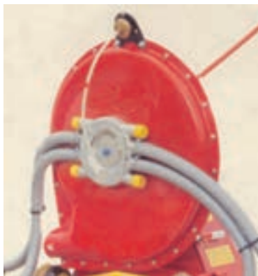
شکل ۷-۱۳- پمپ مکنده و درجه باد
