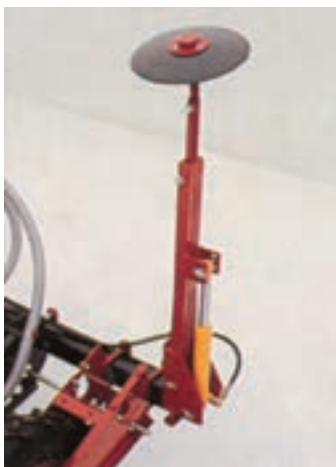
شکل ۷-۱۲- علامتگذار و جک هیدرولیکی متصل به آن
