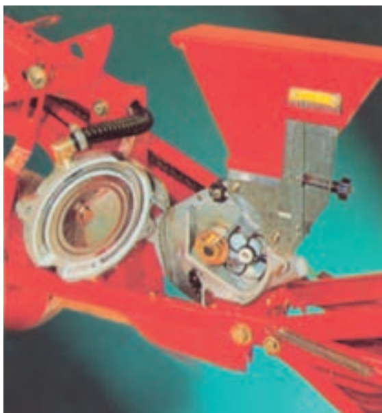
شکل ۷-۱۶- تعویض صفحه بذر
