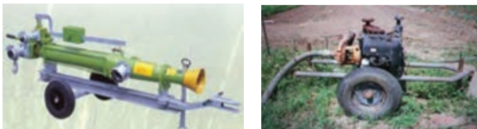
ب) پمپ با نیروی انتقال نیروی تراکتور متصل به گاردان پمپ
