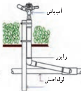
(الف) آب‌پاش نصب شده روی رایزر
