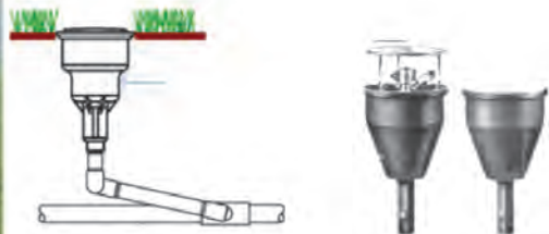
الف) ساختار آب پاش مخفی شونده ب) چگونگی نصب آب پاش
