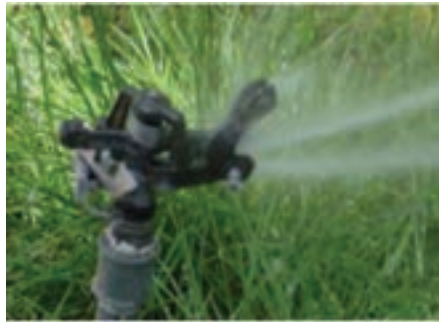
شکل ۲۰-۷- آب پاش ضربه‌ای کند در حال پاشش
