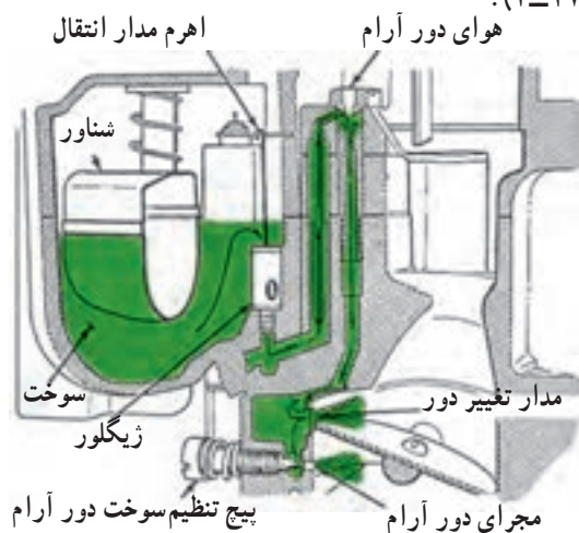
شکل ۴-۱۶- مدار دور آرام
