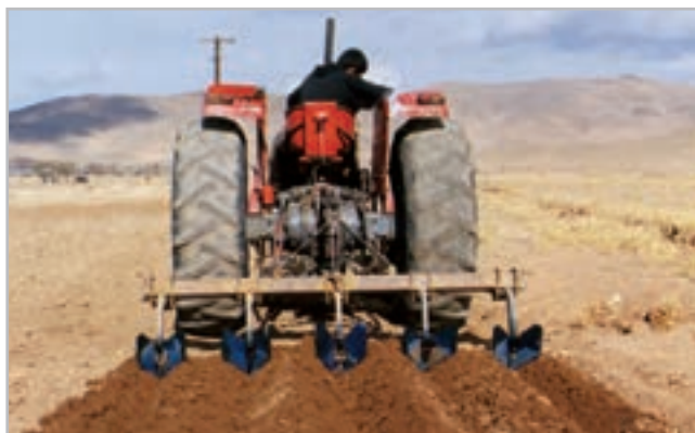
شکل ۳-۱- دستگاه شیارکش در حین کار
