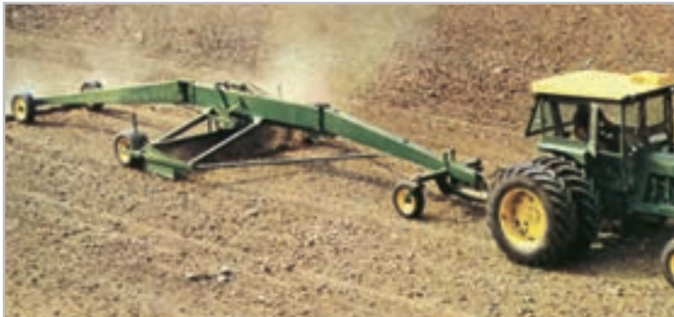
شکل ۲۷ - ۲ - تسطیح‌کن کششی سنگین حین کار
