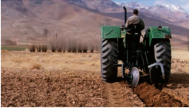
شکل ۳-۳- مرکزکش بشقابی در حین عملیات مرکزشی
