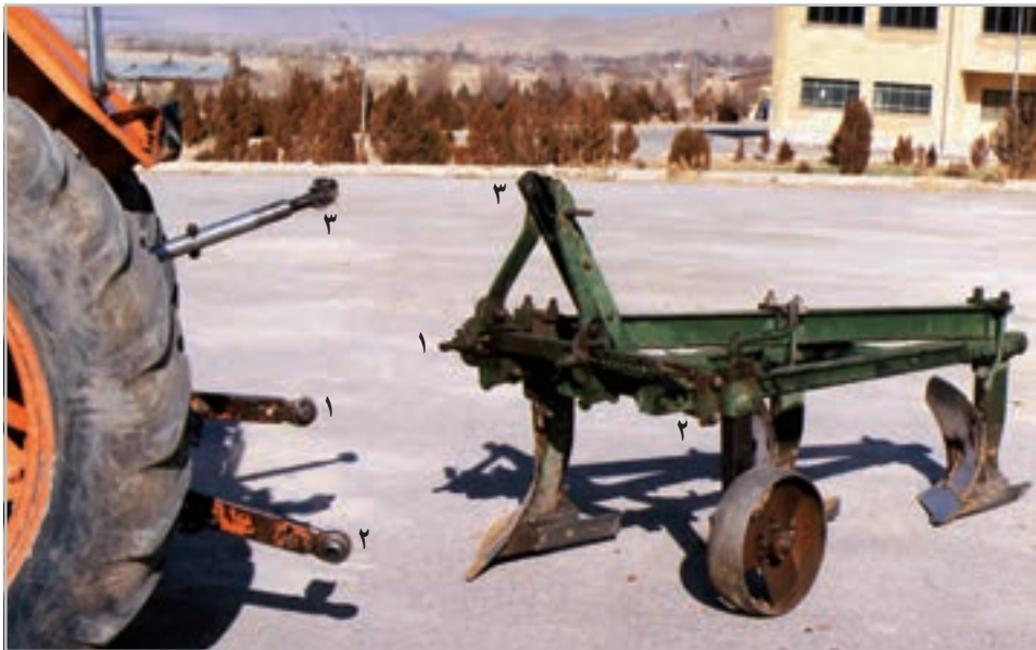
شکل ۲۰-۱- نقاط سه‌گانه اتصال گاوآهن و تراکتور
