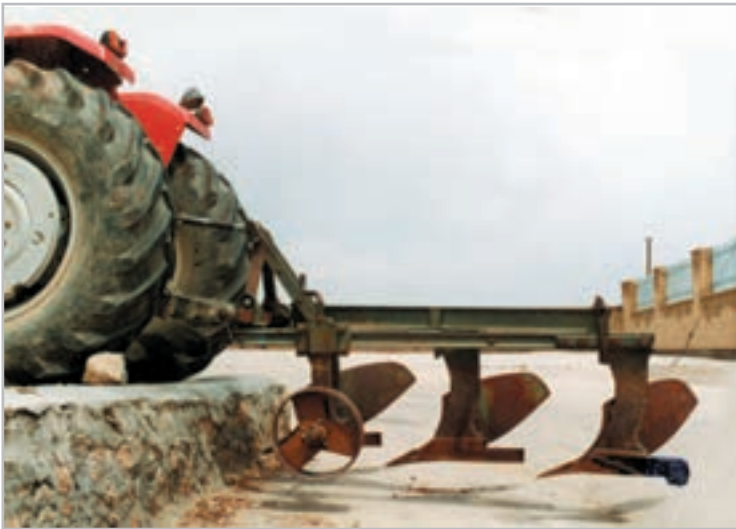
شکل ۲۶-۱- نحوه تنظیم عمق کار گاوآهن
