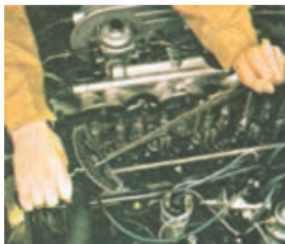
کاربرد آچار درجه‌دار در بستن سرسیلندر
