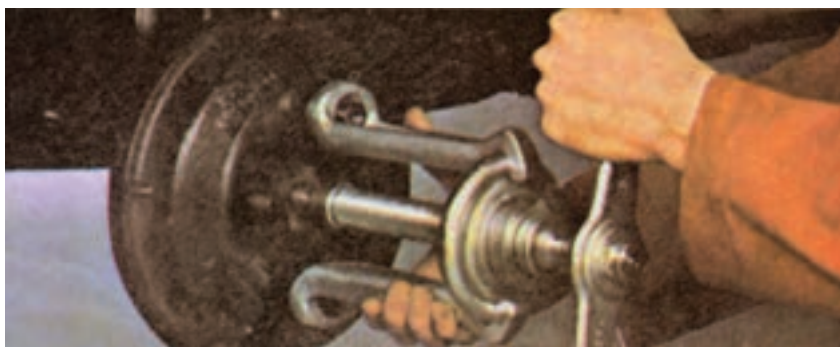
شکل ۱-۳۴- روش درآوردن کاسه چرخ
