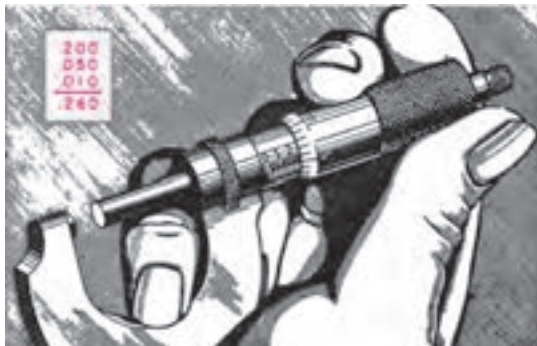
شکل ۵۴-۱ روش به دست گرفتن میکرومتر
