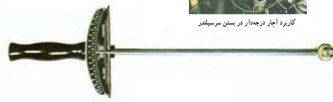
شکل ۸-۱ آچار درجه‌دار و کاربرد آن
