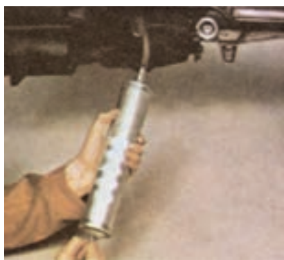
شکل ۳۹-۱- روش پر کردن گیربکس
