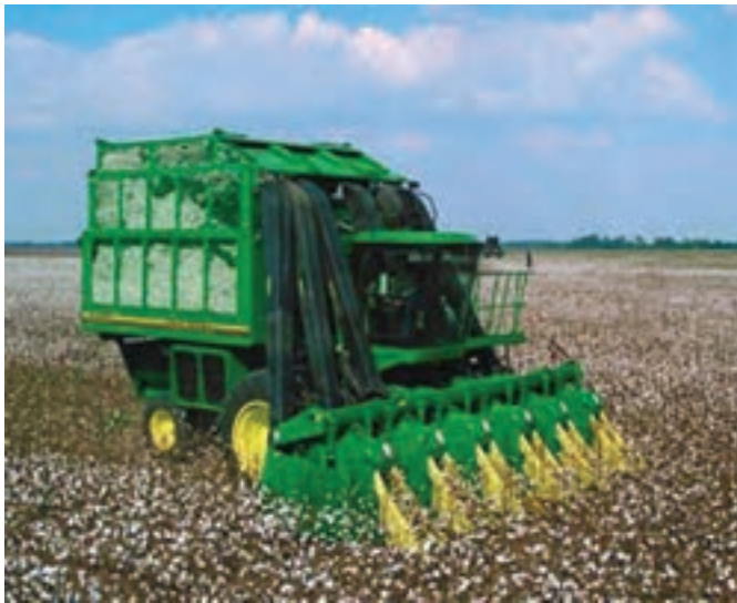
شکل ۴-۲۸- ماشین پنبه چین
