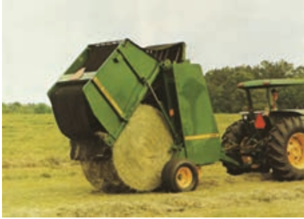
شکل ۱۴-۴- ماشین بسته‌بند استوانه‌ای
