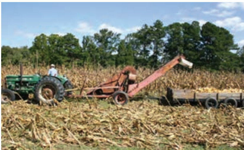
شکل ۳۰-۴ — یک ذرت چین کششی دو ردیفه با بستر پوست کن و پی نورد
