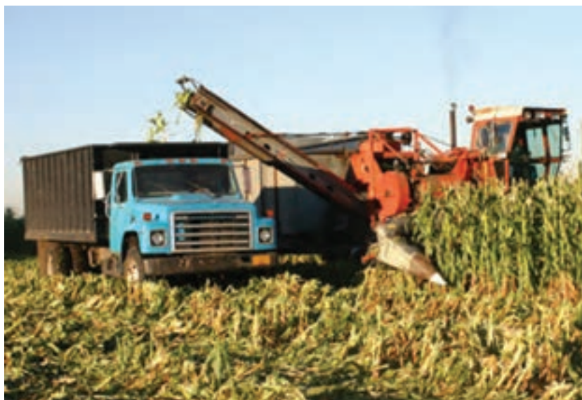
شکل ۳۱-۴ — یک ذرت چین تراکتور سوار دو ردیفه با منظم دانه کن
