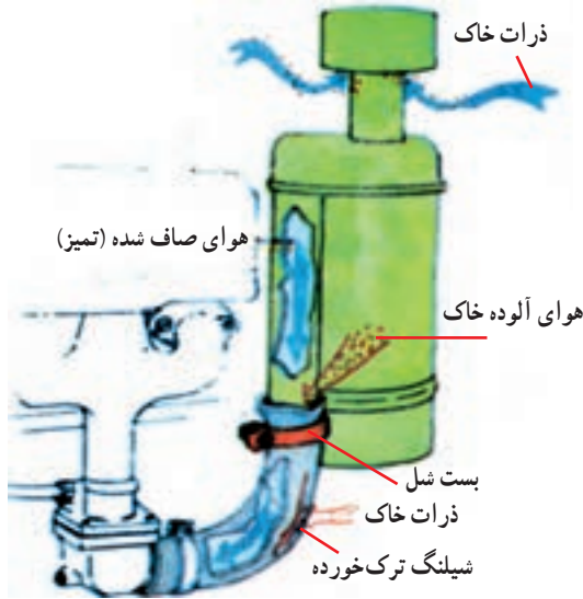
شکل ۴-۵ عوامل کاهش کارایی صافی
