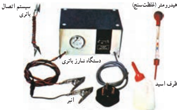
شکل ۴۴-۴- برخی از وسایل شارژر باتری
