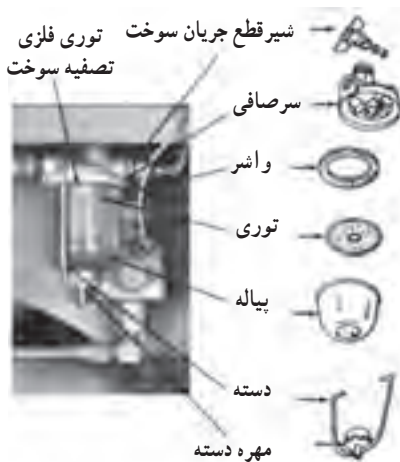
شکل ۱۳-۴- پیاله رسوب گیر زیر مخزن سوخت
