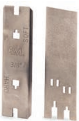
شکل ۲۷-۲- راهنمای تنظیم محدودکننده عمق
