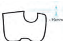
محدودکننده عمق صحیح ۰/۶۵ تا ۰/۹ میلی متر
