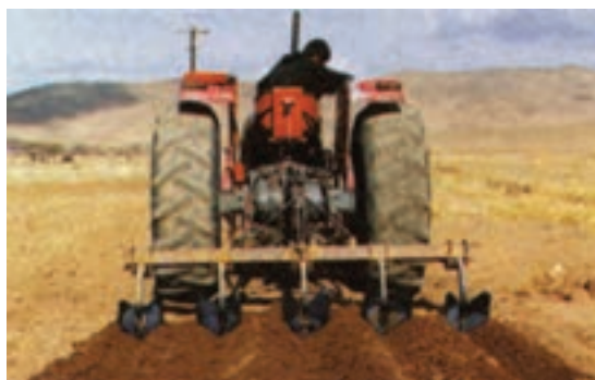
شکل ۴۵-۱- شیارکش نوع بیلچه ای
