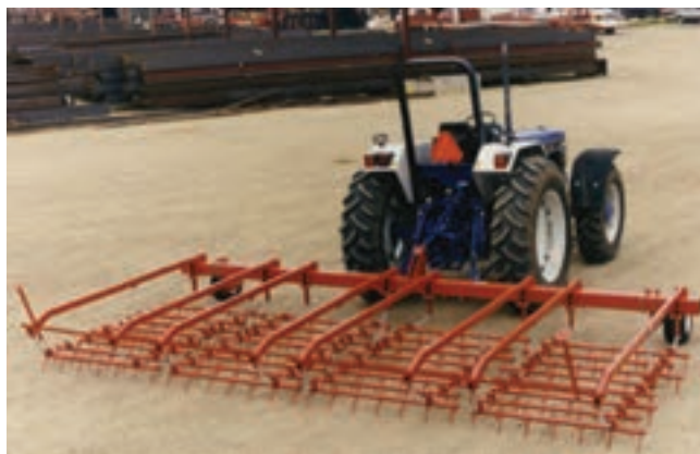
شکل ۱-۳۰- اتصال چند قاب به مالبند
