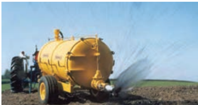
شکل ۱-۳۷- یک نوع کودپاش کود دامی مایع
