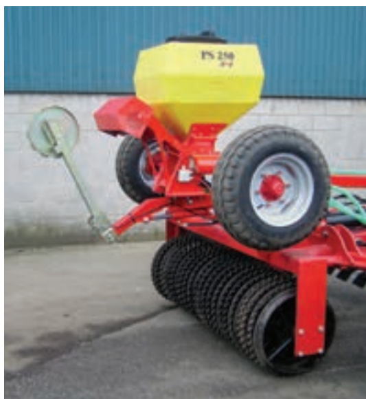
ب- غلتک کمبریج بر روی ماشین مرکب
