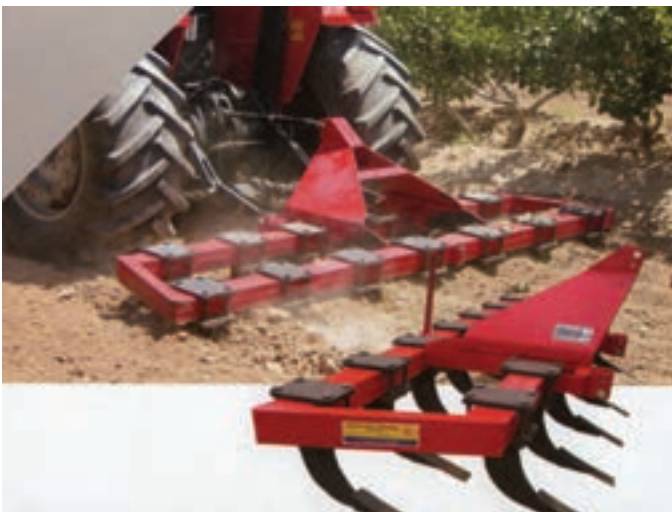
شکل ۱-۱۸- یک گاو آهن زیرشکن چندساقه‌ای
