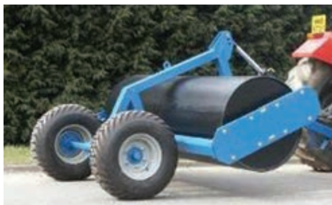
شکل ۱-۳۶- غلتک رویه صاف
