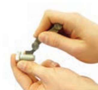
شکل ۱۰-۸- تعیین گام پیچ
