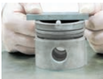
شکل ۶-۸- اندازه‌گیری پیستون با گلوله‌ی اندازه‌گیری
