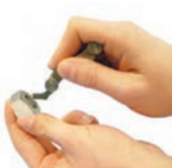
شکل ۱۳-۸- تعیین تعداد دندانه در یک اینچ مهره
