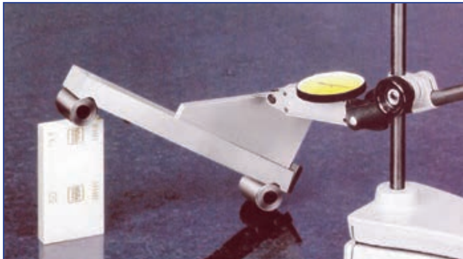
شکل ۷-۱۶- اندازه‌گیری زاویه به کمک خطکش سینوسی
