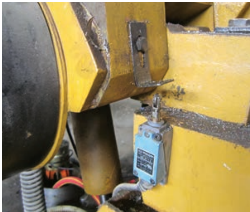
شکل ۵-۸۶ دستگاه در حال برش و تیغه فلزی دستگاه به لیمیت سویچ برخورد نکرده است.
