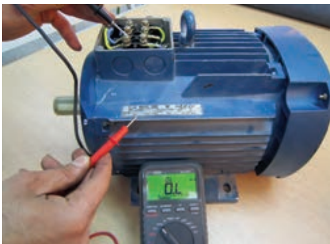
شکل ۵-۸ تست اتصال بدنه.
