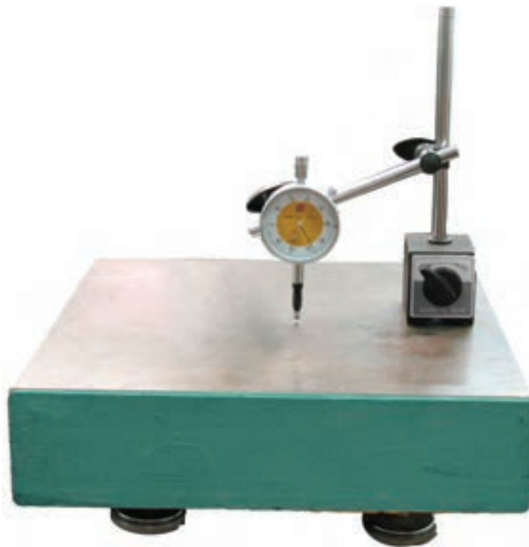
شکل ۲۰-۶- آماده‌سازی ساعت برای عملیات اندازه‌گیری
