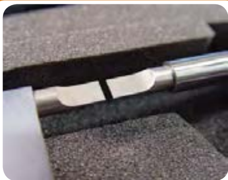
به فرم انحنا دار روی استوانه های فک میکرو متر توجه کنید.
