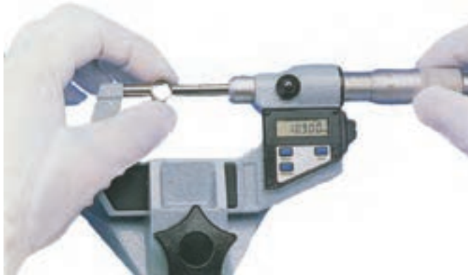
شکل ۳۱-۵ اندازه‌گیری به وسیله میکرومتر دیجیتالی
