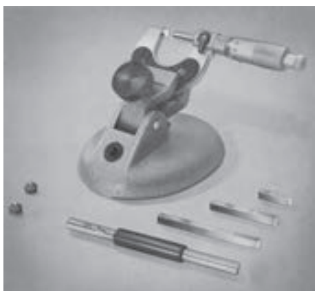
شکل ۲۳-۵- بستن میکرومتر به گیره مخصوص (پایه مخصوص)
