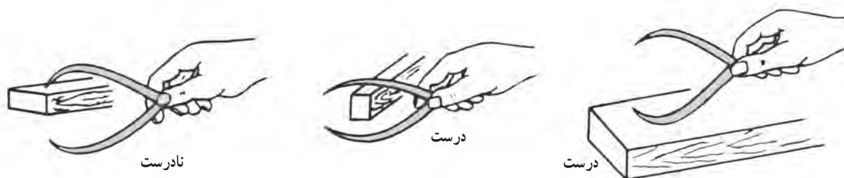
شکل ۲-۲۷- تنظیم دهانه پرگار انتقال اندازه خارج
