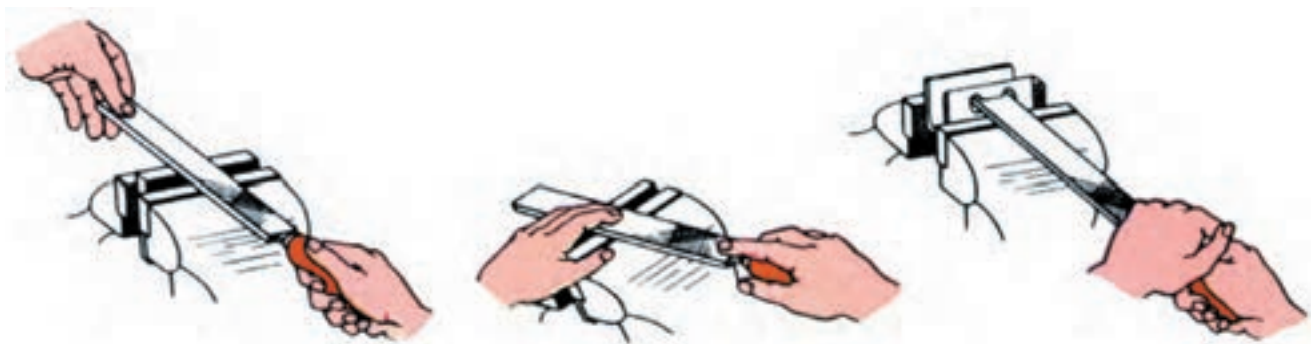
شکل ۶-۵ - استفاده از دست چپ در سوهان‌های متوسط
